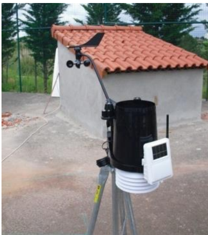
Figura 2 – Estación meteorológica (Wireless Vantage Pro2™ Plus).
